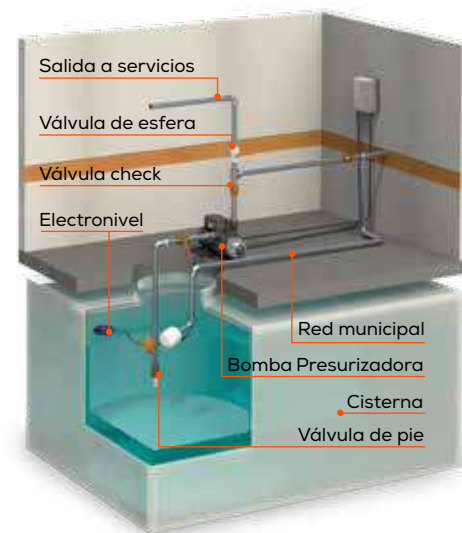
DIAGRAMA DE INSTALACIÓN
