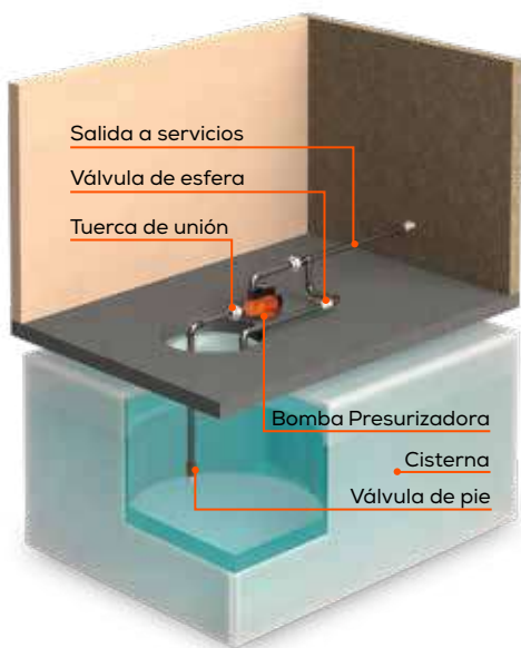
DIAGRAMA DE INSTALACIÓN
